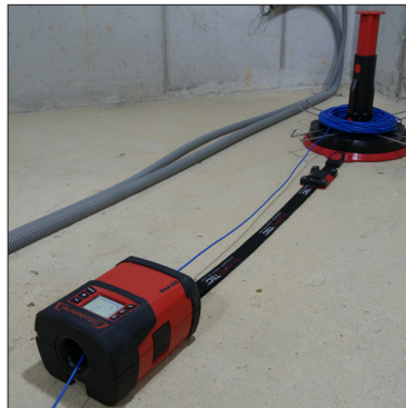
RM35 mit XB 300 und Multifunktionsdorn mit Einzelader
