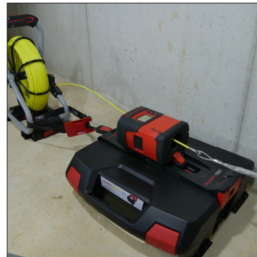
RM35 mit Montageplatte-Systemkoffer , Glasfasereinziehsystem Ø 4,5 mm
