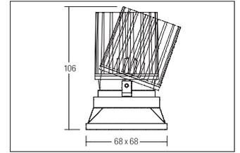
LED-System-Einbaustrahler COUPLED, vertieft, dim2warm, weiß, quadratisch. Ausgeführt in kompakter Bauform für werkzeuglose Schnellmontage zum Deckeneinbau. Wird die Leuchte gedimmt, verringert sich die Farbtemperatur.
